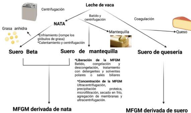
Figura 7. Diagrama del aislamiento industrial de la membrana del glóbulo de grasa de la leche bovina para su utilización en la formulación de las leches infantiles. Gráfico de elaboración propia.
